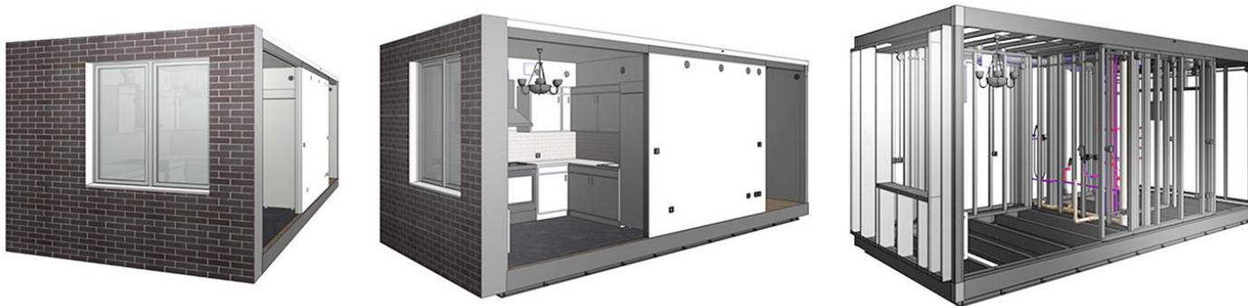
ВІМ модели позволяют проектировщикам получать полные характеристики, спецификации, объемы материалов и элементов как каждого модуля, так и модульного дома в целом.
